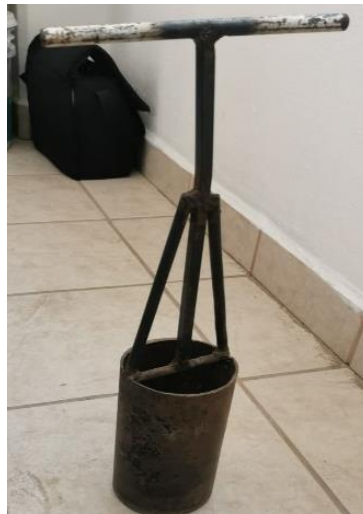
Figura 26 Barreno de suelo con una profundidad de 30 cm
