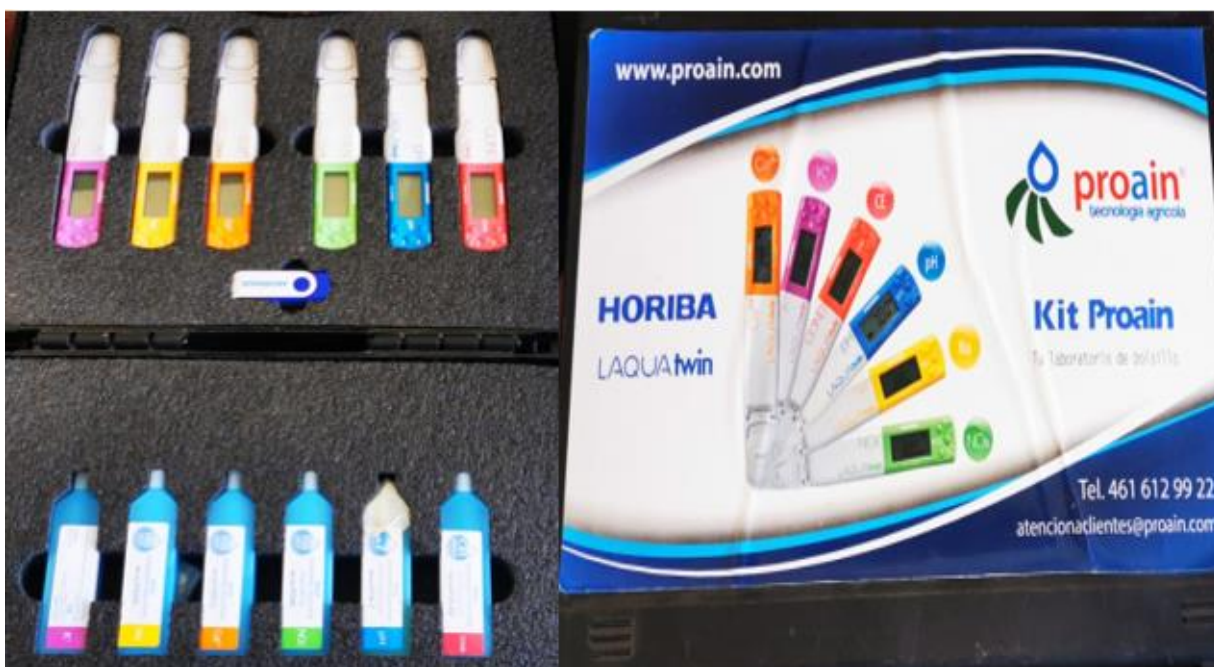
Figura 4 Kit de medidores de nutrientes de la marca HORIBA, Modelo LAQUA Twin
