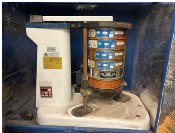
Figura 10 Tamices U.S.A Standard Testing Sieve VWR en un Rotap Tyler RX-29-10
